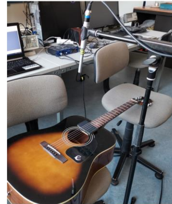
Ugrásválasz rögzítése mikrofonnal
