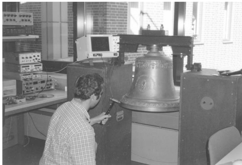
4.6. ábra. Az őcsényi harang mérése
