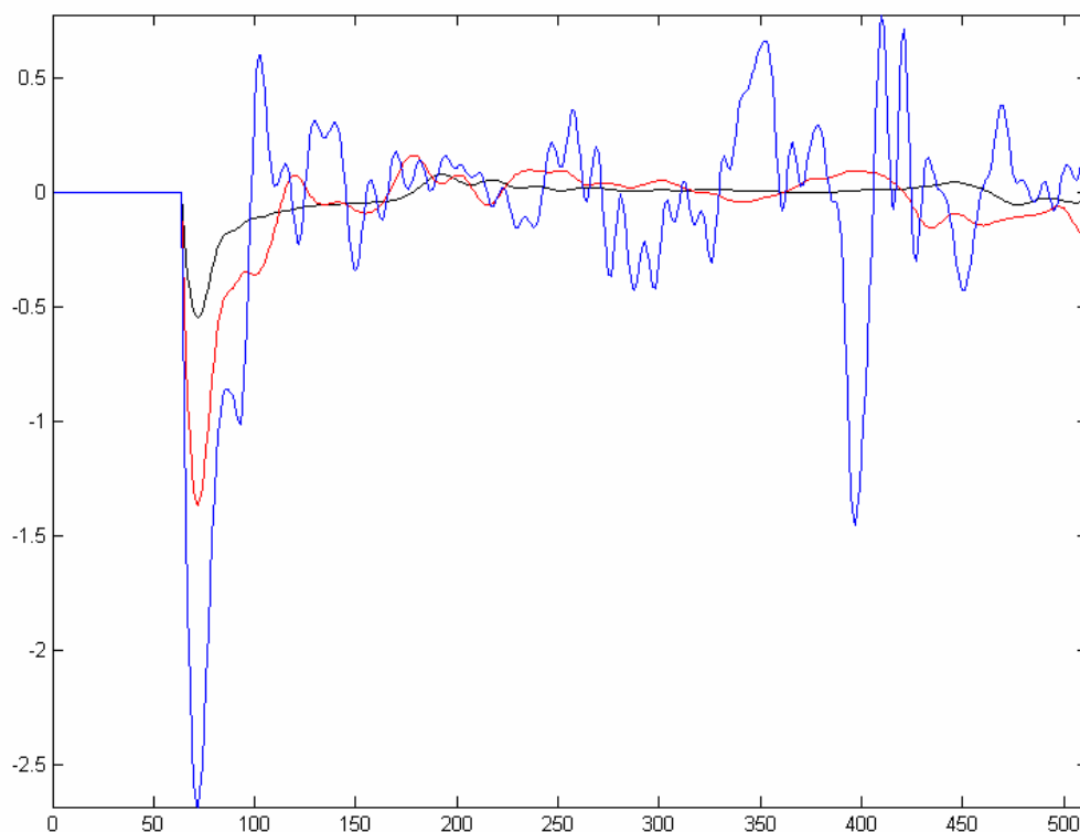
3.3.4.3. ábra. Nemlineáris membrán kitérésének időfüggvénye, ha a gerjesztés amplitúdóját 2,5 ill. 5-szörösére növeljük
