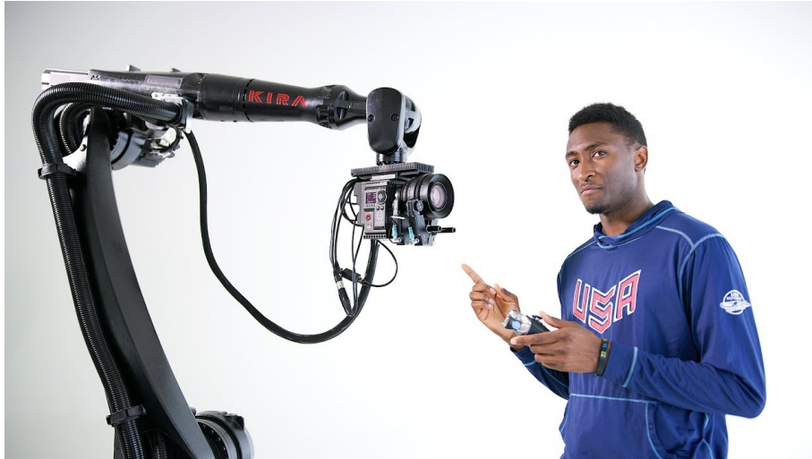
1.1. ábra. A Motorized Precision által forgalmazott KIRA videó-rögzítő robotkar [6]
