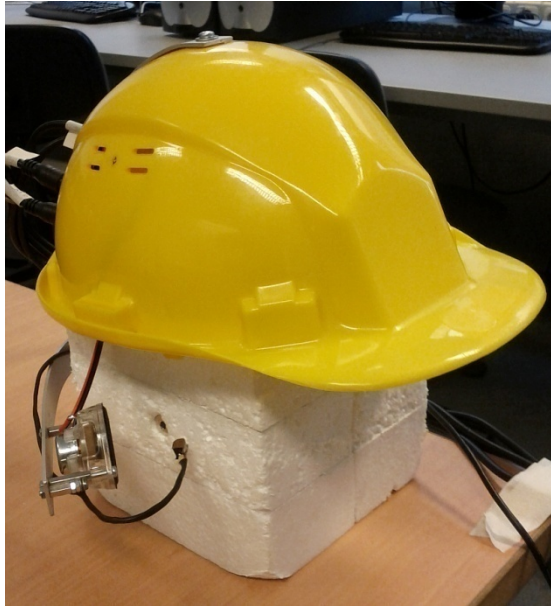
6.1. ábra – A zajcsökkentő sisak mérési elhelyezése
