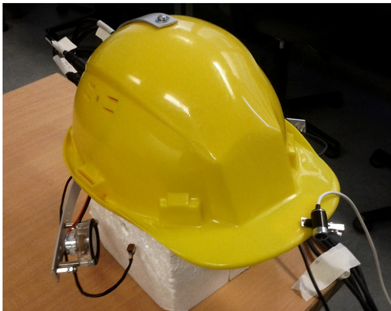
6.4. ábra – Egy referenciamikrofon optimális elhelyezése
