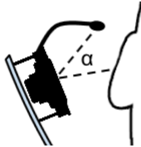
4.2. ábra – A zajmikrofon, a hangszóró és a fül helyzete
