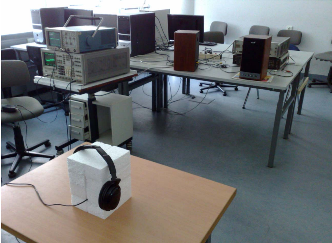
2.2. ábra – A fejhallgatók tesztjének mérési elrendezése
