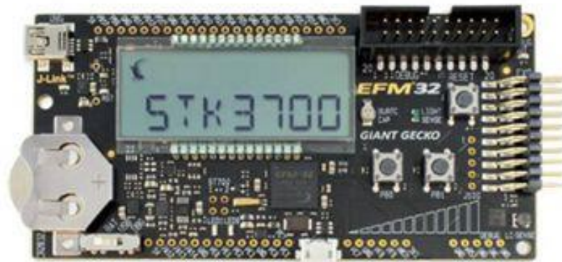
4.1. ábra: EFM32GG-STK3700 Giant Gecko Starter Kit képe[8]
