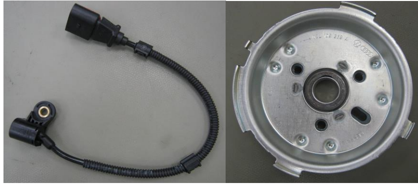
4. ábra: Vezérműtengely jeladó szenzor és a tárcsája
