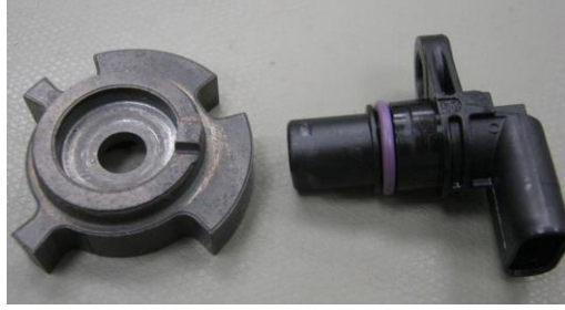
10. ábra: Másik típusú vezérműtengely jeladó
