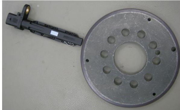
6. ábra: Főtengely jeladó és sokpólusú tárcsája
