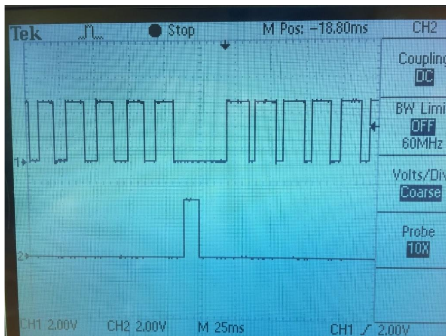
4-5. ábra: Strobe jel kiküldés mérése oszcilloszkópon
