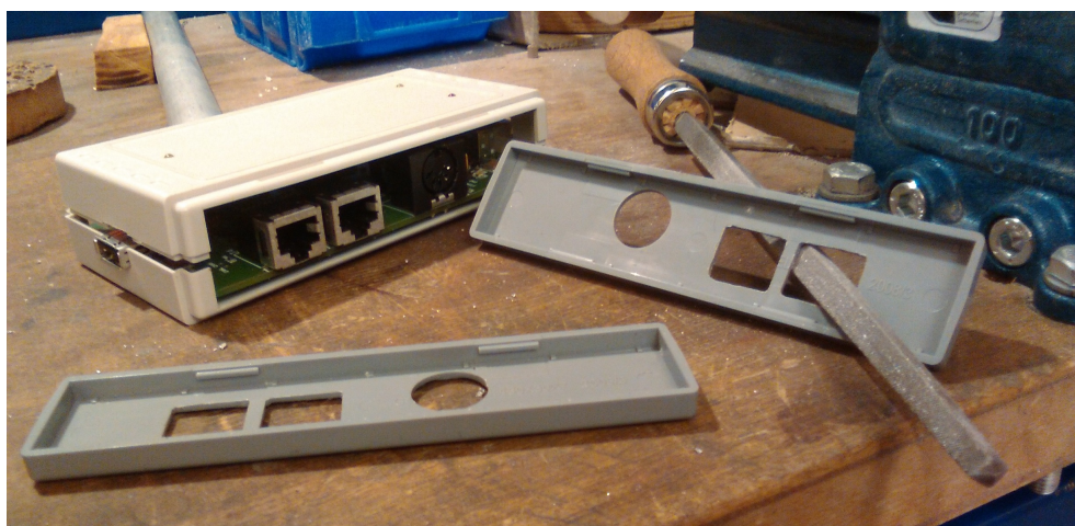
5.17. ábra. Áramkörgyártás: A műszerdoboz mechanikai kialakítása
