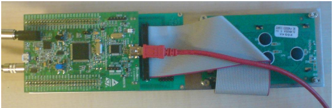
4-15. ábra Az alumínium lemezre rögzített áramkör (hátnézet)
