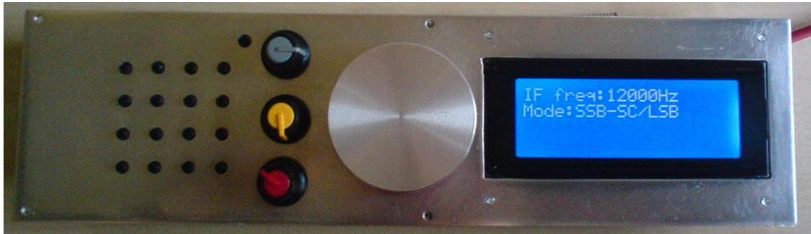
4-14. ábra Az alumínium lemezre rögzített áramkör (előlnézet)
