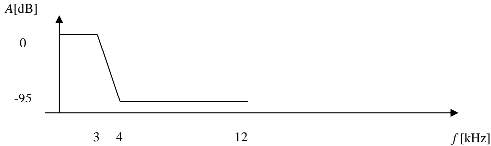
6-7. ábra Háromszorozó interpoláló szűrő
