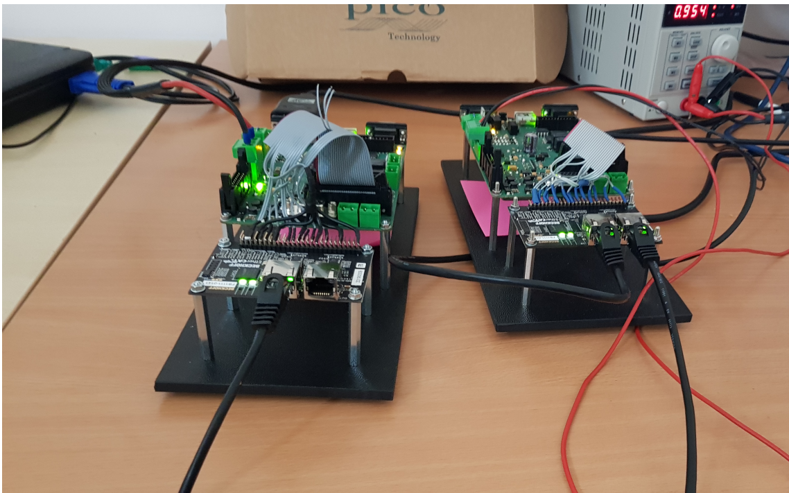
5.8. ábra. A működő EtherCAT hálózat két Slave egységgel
