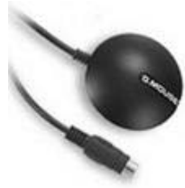
4.4. ábra. GLOBALSAT BR-355 típusú GPS vevő
