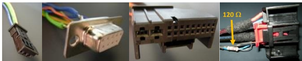
20. ábra: A csatlakozók balról jobbra: LIN Slave, 9-pólusú D-SUB, klímavezérlő szemből, klímavezérlő oldalnézetből
