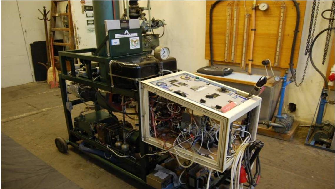
21. ábra: A TKT-1-es gázturbinás sugárhajtómű fékpadra szerelve
