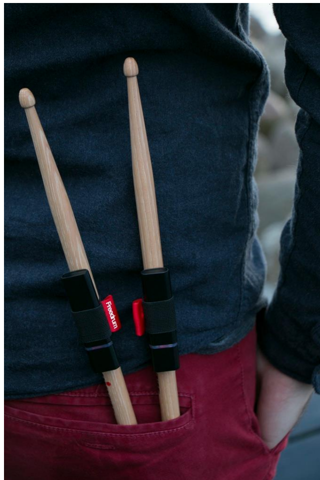
2.3. ábra: Freedrum inerciális szenzor alapú virtuális dobszett
