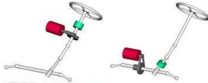
2-3. ábra Kormányoszlop rásegítés, és fogasléc rásegítés [3]
