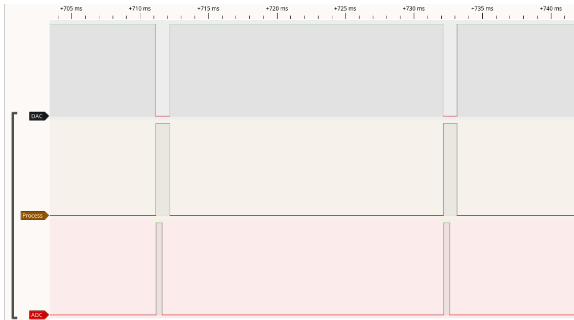
41. Ábra: Futási idő mérése valós szűrés közben Pi 2 eszközön Pulseview program segítségével
