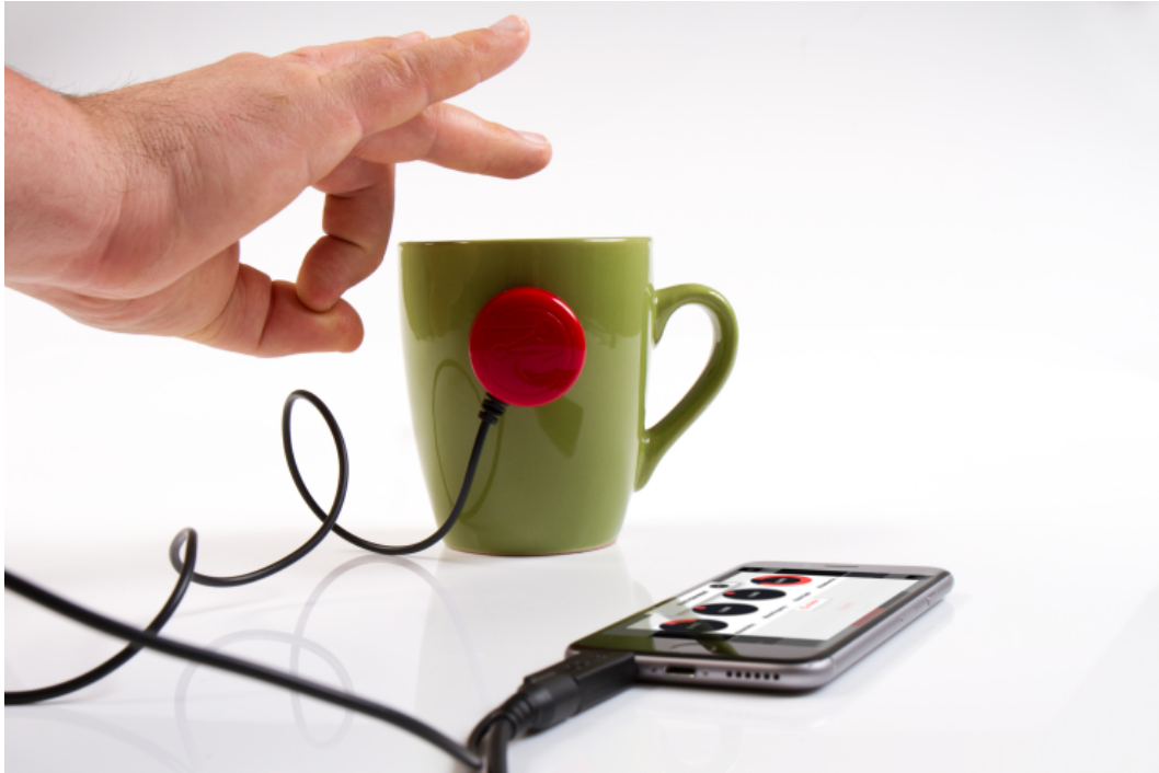
1.8. ábra. Bögrére rögzített Mogeas szenzor [17]
