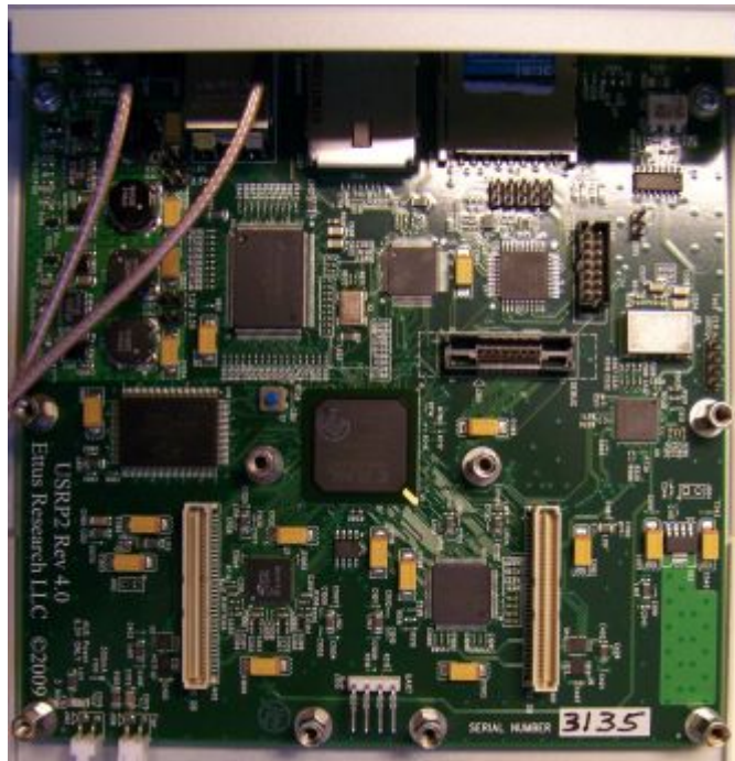
8.4. ábra: Az USRP2 alaplapi motherboard kártyája
