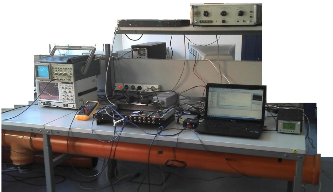
3.8. ábra. A megvalósított ANC rendszer mérés közben
