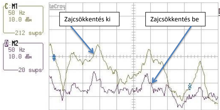
5.3. ábra. Zajcsökkentés eredménye (FXLMS algoritmus) Gauss-zaj esetén
