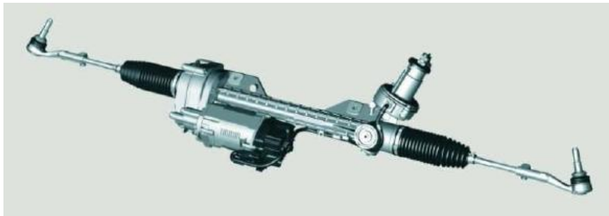
1.3.1. ábra : Párhuzamos kialakítású elektromechanikus szervokormány
