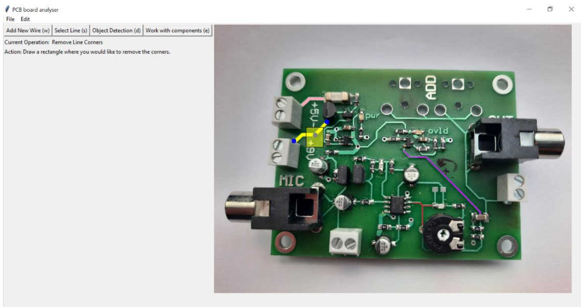
45. ábra – Kiválasztott vezetékhez tartozó sarokpont törlése
