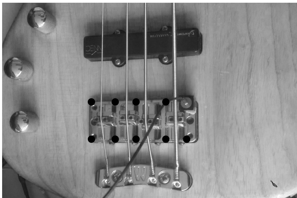
4.3. ábra. A gitárhíd mérése gyorsulásmérővel. A fekete körök jelzik a kalapáccsal gerjesztett pontokat, a híd jobb felső sarkán a gyorsulásmérő látható.
