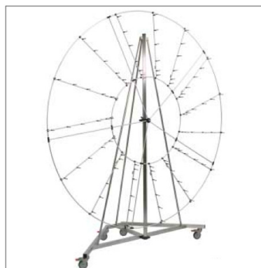
8.3. ábra. A Brüel & Kjaer cég által fejlesztett 90 csatornás, kerék elrendezésű mikrofontömb megvalósítása [3]
