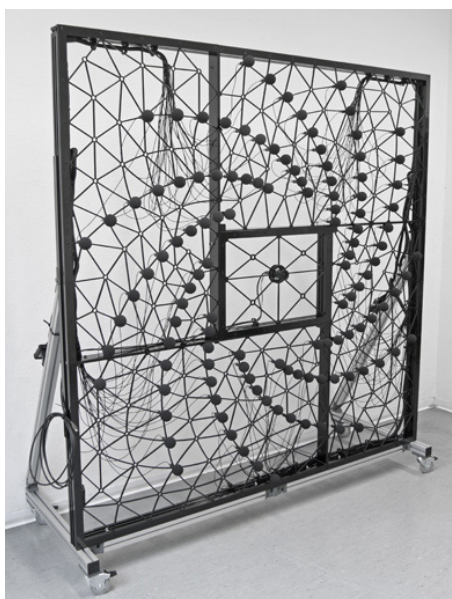
8.4. ábra. A GFaI cég 120 csatornás, spirál elrendezésű mikrofontömbje [10]
