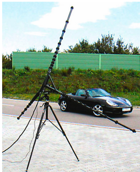
8.6. ábra. Csillag elrendezésű, 36 elemű mikrofontömb, beépített videokamerával és kábelezéssel [10]
