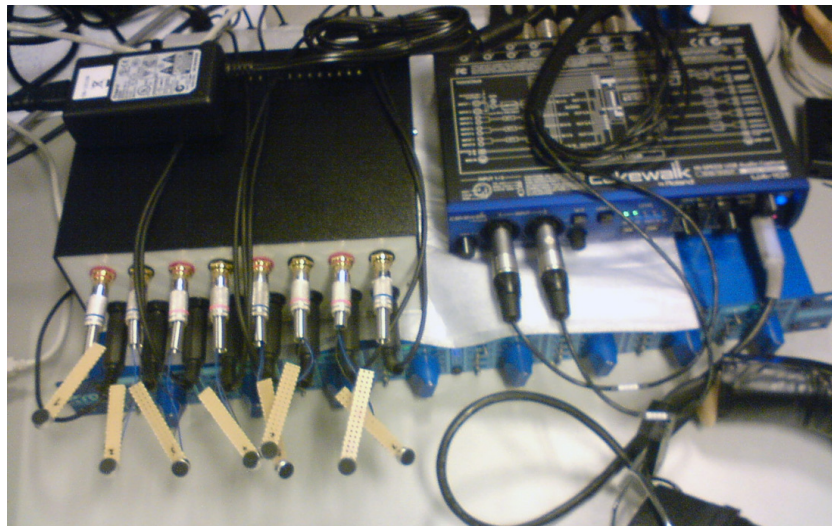
5.5. ábra. A mikrofontömböt, erősítőt, és 10 csatornás USB audio interfészt tartalmazó rendszer
