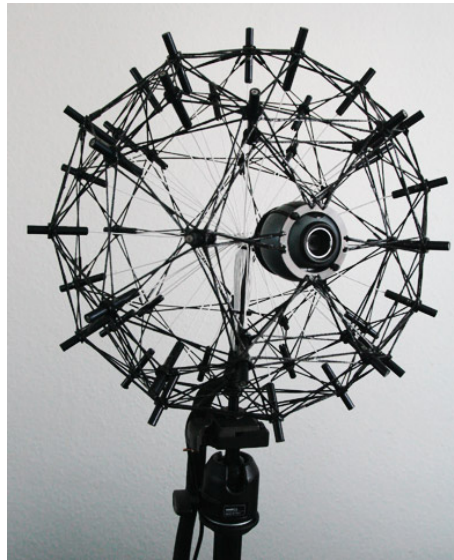
8.5. ábra. A GFaI cég 48 elemű, gömb kialakítású mikrofontömbje [10]
