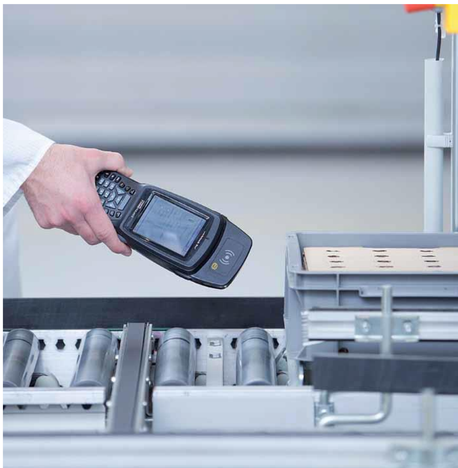
2. ábra A termék azonosítása kézi leolvasóval
