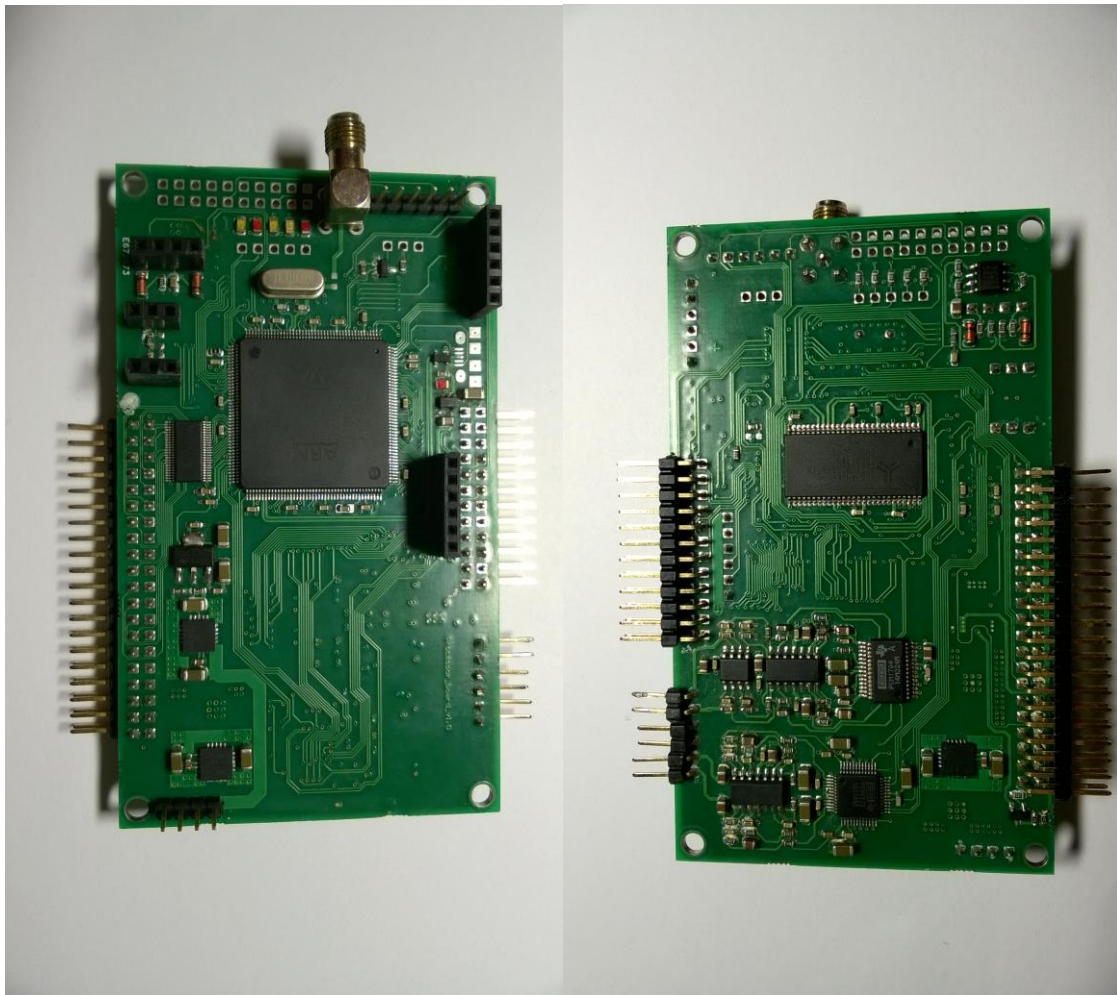
14. ábra Az elkészült processzor kártya
