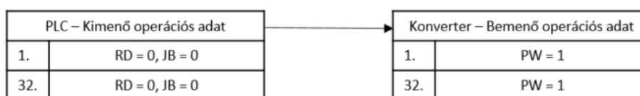
2.6. ábra: A ki és bemenő folyamat adatok az indítást követő, ill. tétlen fázisban
