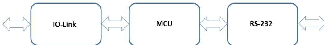
2.2. ábra: IO-Link RS-232 átalakító blokkvázlata
