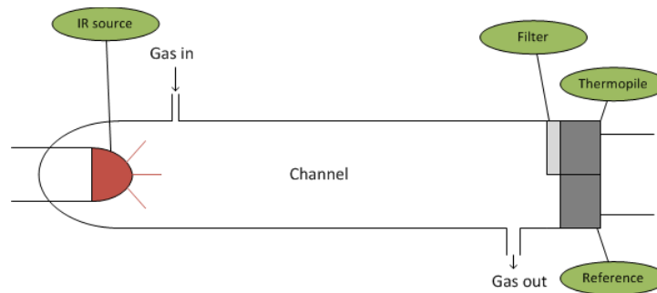
2.8. ábra: Egy csatorna két érzékelő egy tokban
