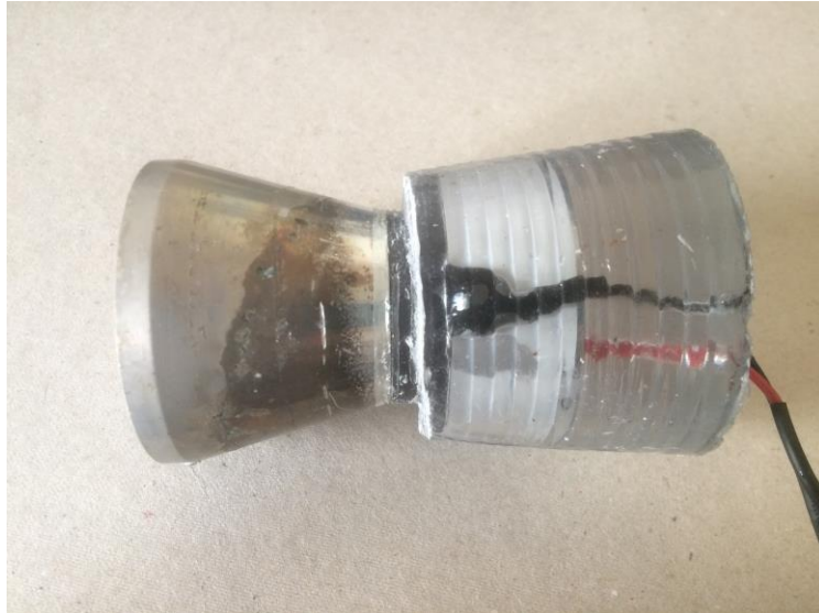
32. ábra A polimergyantával kiöntött transzducer
