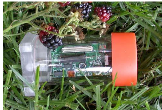
2. ábra: Környezetmonitorozáshoz használt Berkeley mote [16]
