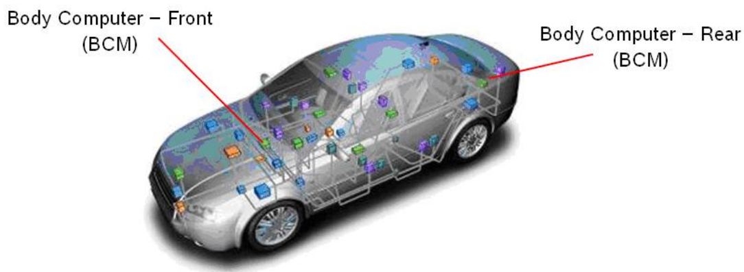
1.3. ábra. Fedélzeti vezérlők tipikus elhelyezése a gépjárműben
