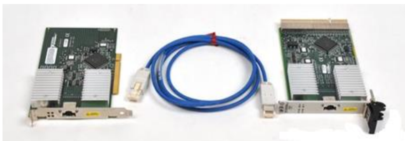
17. ábra. A PC alaplapjába és a PXI keretbe illesztendő kártyák.
