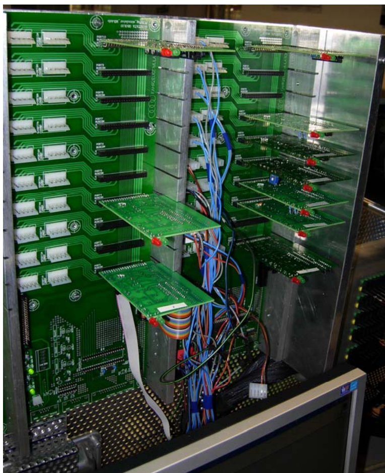
7.3. ábra Az összeállított szimulátorelektronika két összekapcsolt alaplappal, és a szenzorkártyákkal
