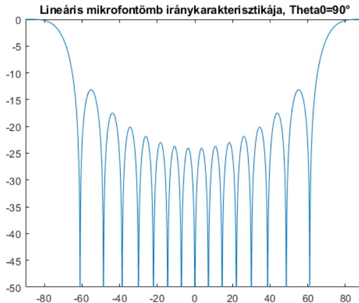
4-12. ábra, lineáris mikrofontömb iránykarakterisztikája, \Theta_0 = 90^\circ
