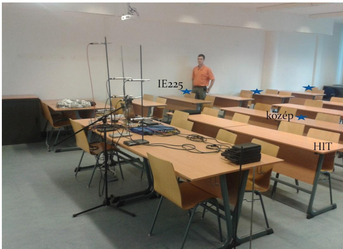
5.2 ábra Egy mérési elrendezés fényképe, a csillaggal jelölt helyek a hangforrás pozíciói
