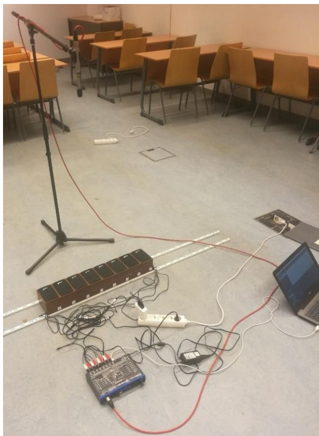
9-1. ábra: Mérési elrendezés (1.): hangszórók átvitelének mérése 0 fokon (on axis)
