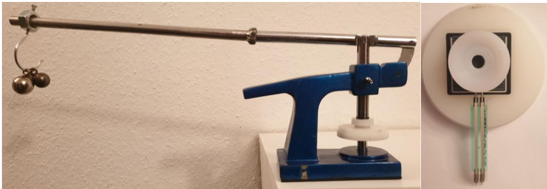
8. ábra Óraüveg- és hátlap behelyező prés és a szenzor nyomására használt prés szerszámlap
