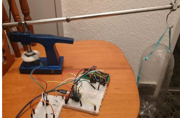
15. ábra A karakterisztika feltérképezésére használt elrendezés
